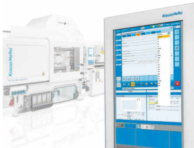
Mit der Maschinenfunktion APC Plus von Kraussmaffei können im Spritzgießprozess störende Schwankungen und Umwelteinflüsse genau und schnell kompensiert werden. Das automatische Regelsystem sorgt für eine vollständige Füllung der Kavitäten im Werkzeug.
