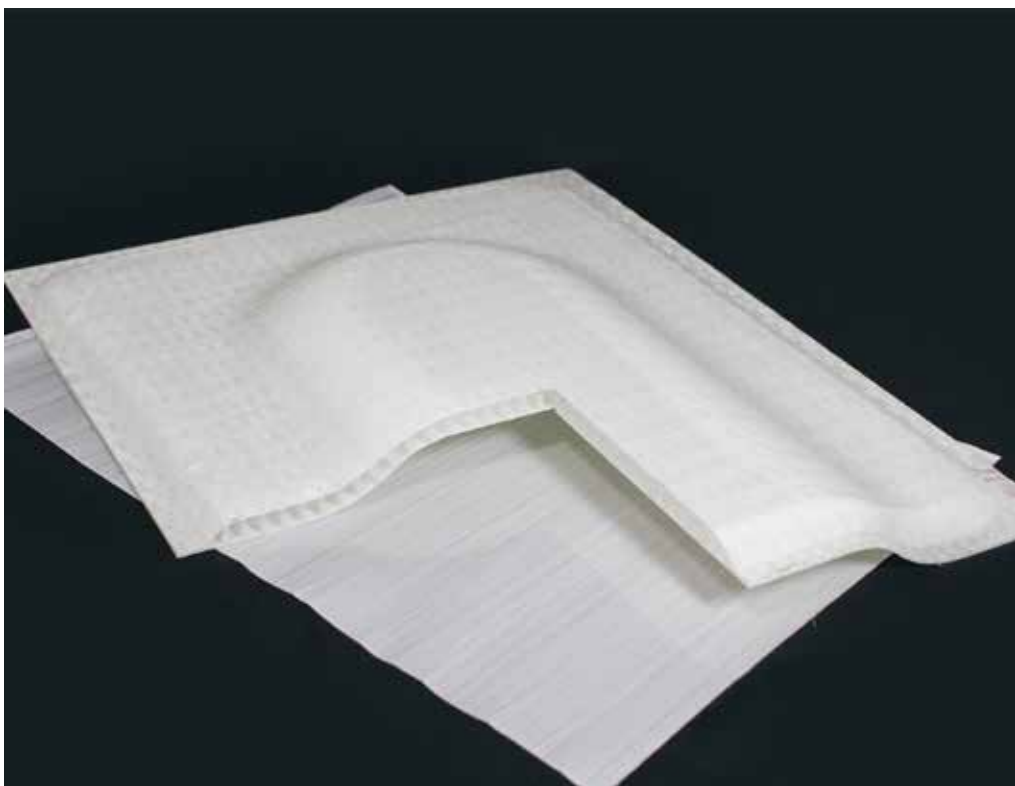
有机夹层是一种热塑性夹层半成品，有着连续纤维增强的覆盖层及内置的蜂窝芯。它为轻结构提供了巨大的潜力。(图：Fraunhofer IMWS)
